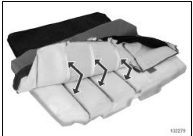
Die Klettverbindungen lösen.
