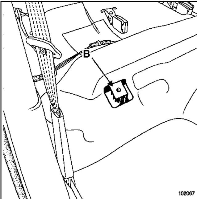
Einen Schraubendreher in die Aussparung (B) schieben.
