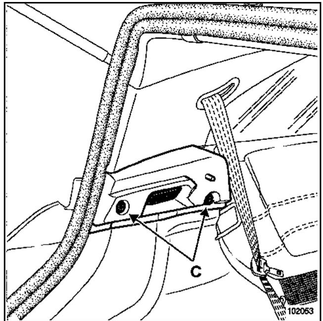
Die Schrauben (C) entfernen.
