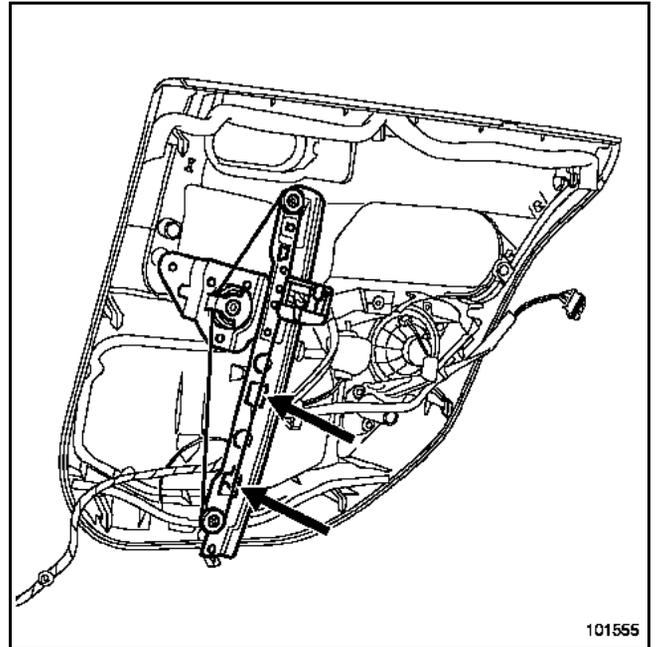
Die Motoreinheit an der Verkleidung einrasten.
