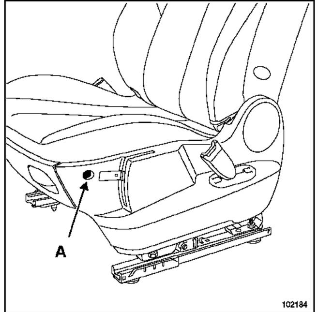
Die Schraube des Gehäuses (A) entfernen.
