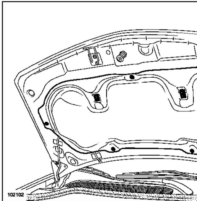
Mit der Ausbaugezange die fünf Klammern lösen.
