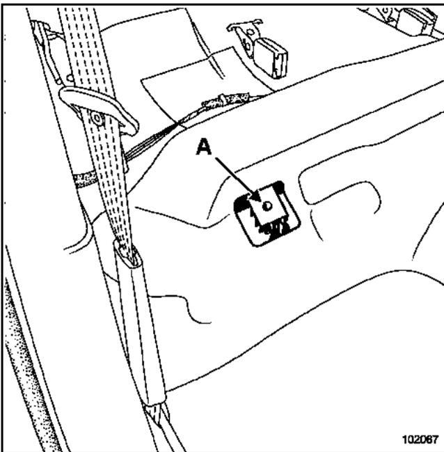
Einen Schlitzschraubendreher in die Aussparung (A) stecken.
