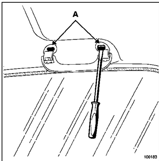
Mit Hilfe des Werkzeugs **Car. 1597** die beiden Befestigungsstifte (A) lösen und danach das Teil von Hand abziehen.
