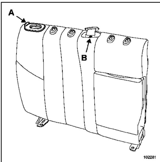
Die Abdeckleiste der Entriegelungsbetätigung entfernen (A).
