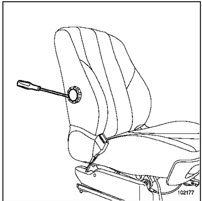
Die Befestigungsabdeckung des Handrads der verstellbaren Lendenstütze mit Hilfe des Werkzeugs **Car. 1597** ausbauen.
