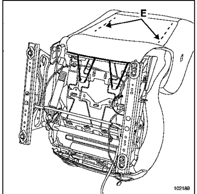
Die unteren Haltegummis des Bezugs der Rückenlehne lösen.
