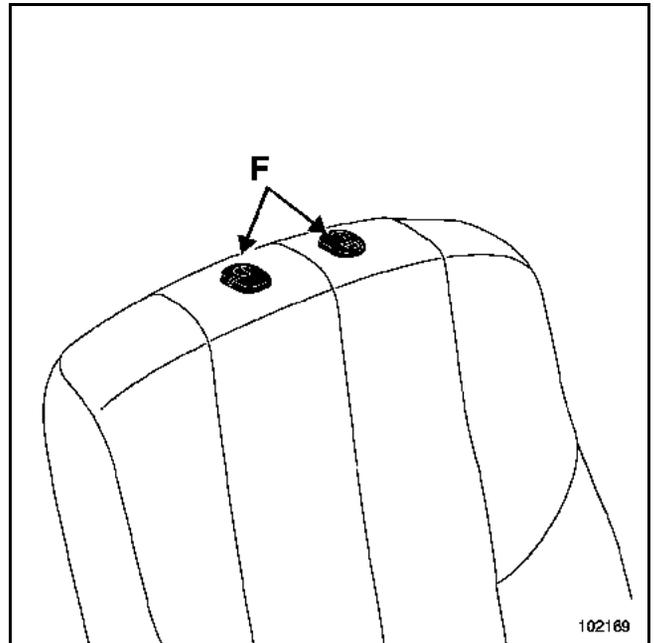
Die Blenden (F) der Kopfstützenführungen entfernen.
