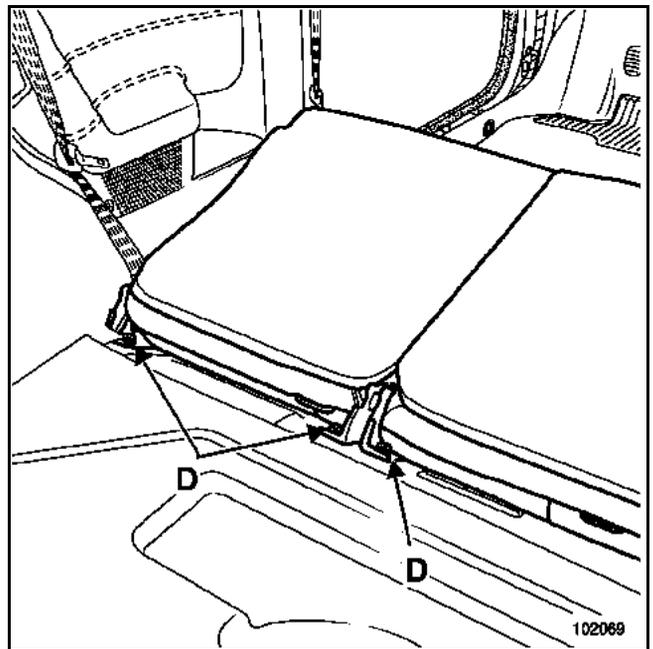
Die hinteren Befestigungen (D) lösen, aber nicht entfernen.
