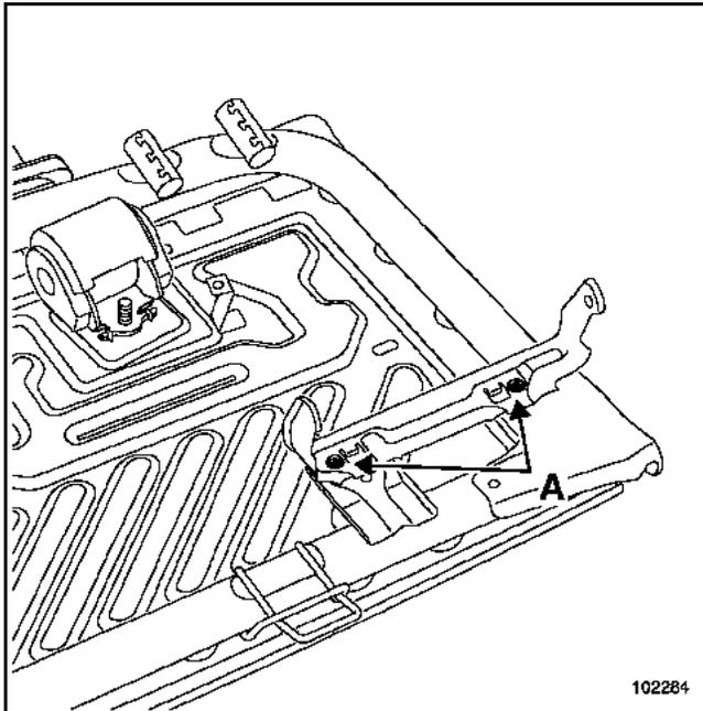
Die Schrauben der Armstützenhalterung (A) entfernen.
