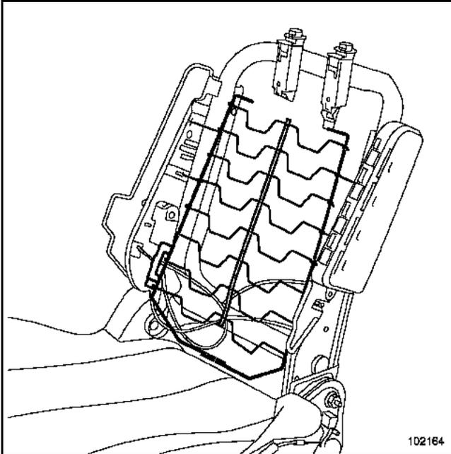
Das Gitter der Mechanik zur Lendenstützeneinstellung ausbauen.
