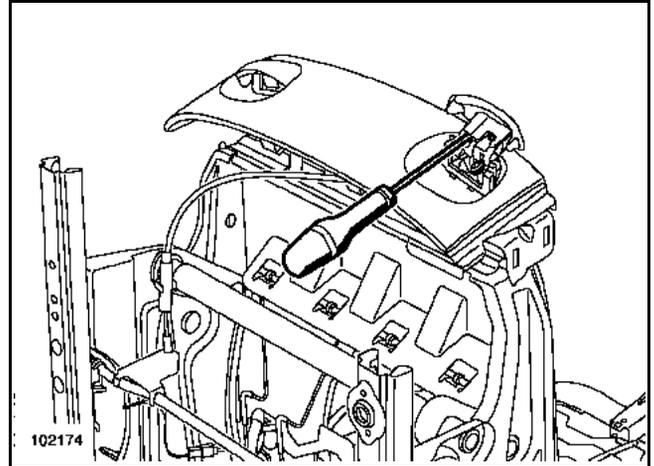
Die Befestigungsschraube des Griffs zur Einstellung der Sitzschienen entfernen.
