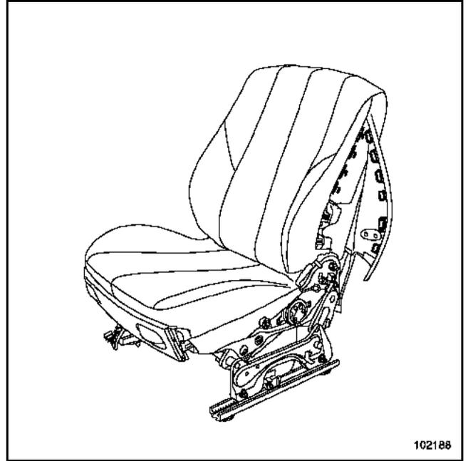
Die Klammern des Bezugs am Airbag aushaken.
