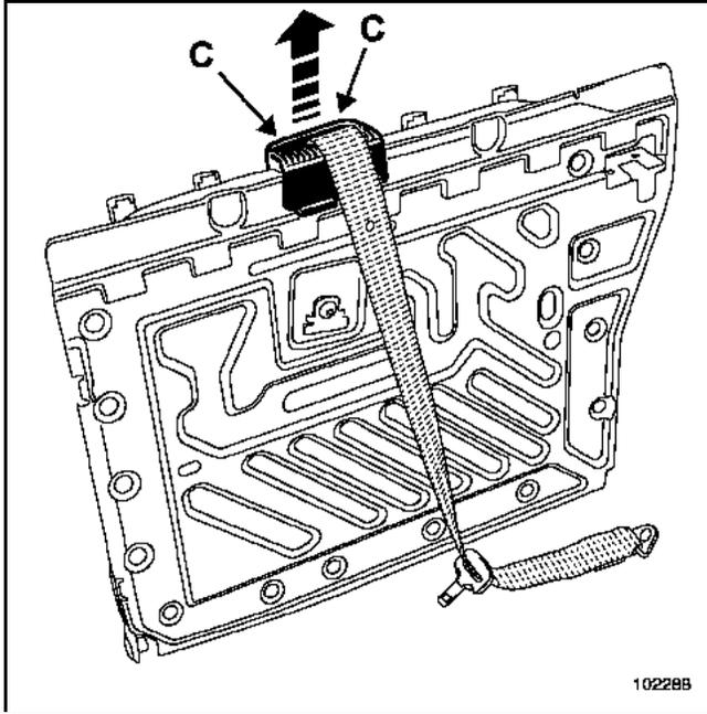
Die Schrauben (C) entfernen.
