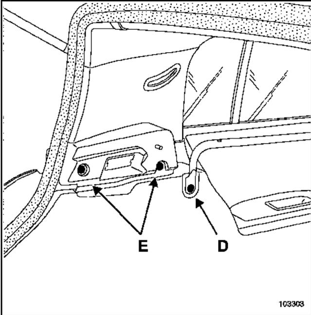
Die Schraube (D) lösen, ohne sie zu entfernen.
