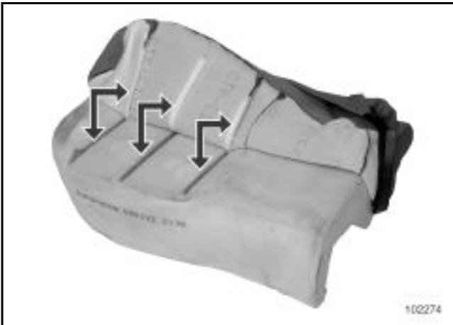
Die Klettverbindungen lösen.
