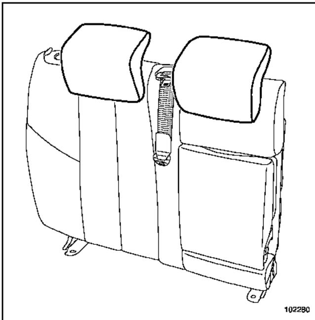
Die Kopfstützen entfernen.
