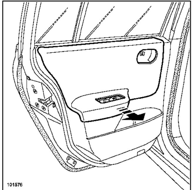
Die Abdeckung mit Hilfe der Ausbaugezange von der Verkleidung abnehmen (hierbei die Verkleidung schützen).
