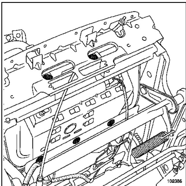
Die Befestigungsschrauben des Anti-Submarining-Airbags entfernen.
