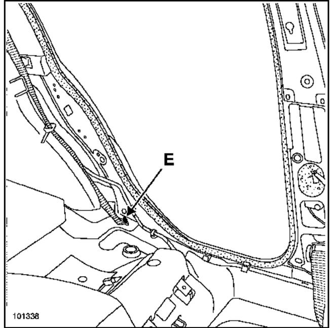
Die untere Befestigungsschraube des Sicherheitsgurts (E) lösen.
