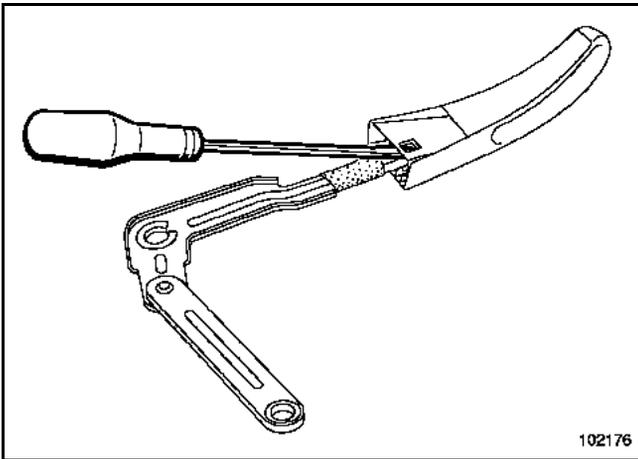
Den Griff der Sitzkissenerhöhung mit Hilfe eines Schlitzschraubendrehers ausrasten.
