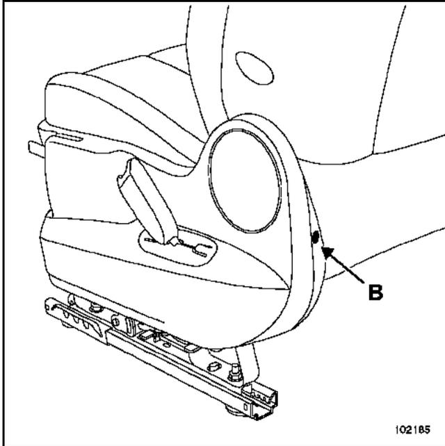
Die Schraube (B) des Gehäuses entfernen.
