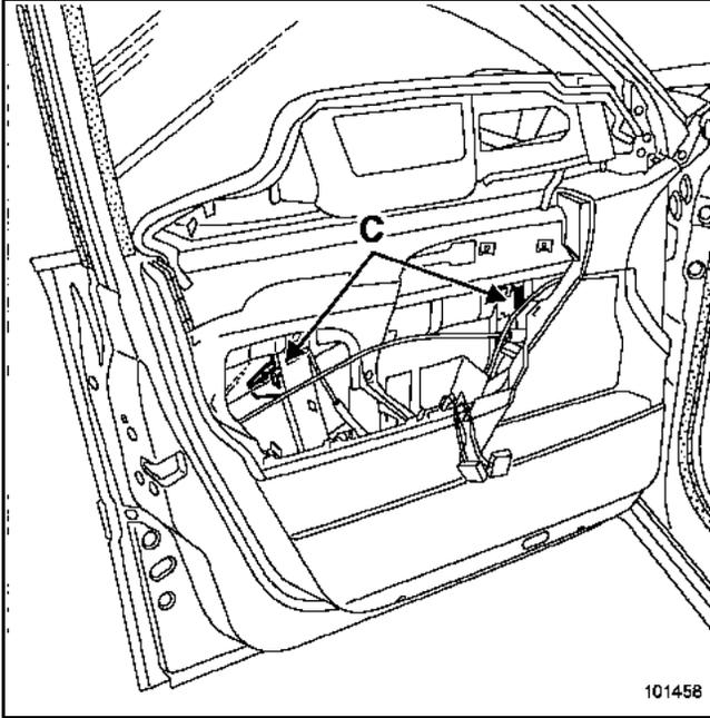
Die Scheibe so positionieren, dass die beiden Halteklammern (C) zugänglich sind.
