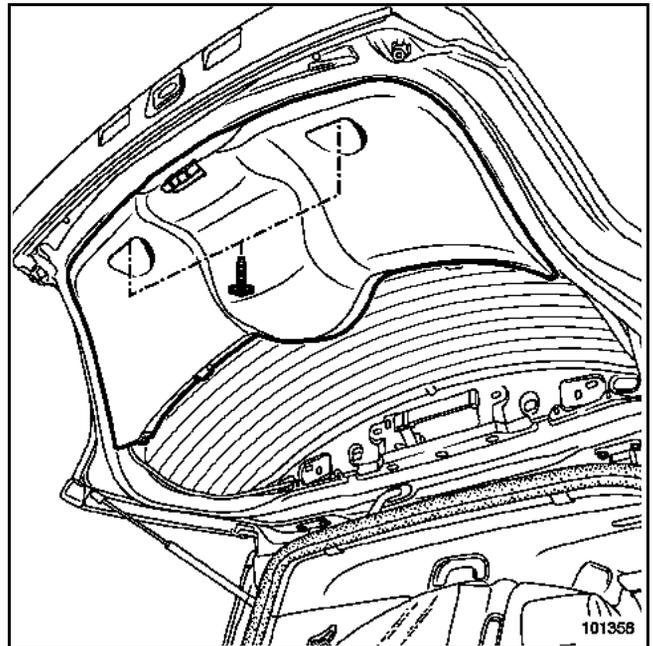
Die beiden Schrauben der unteren Verkleidung entfernen.
