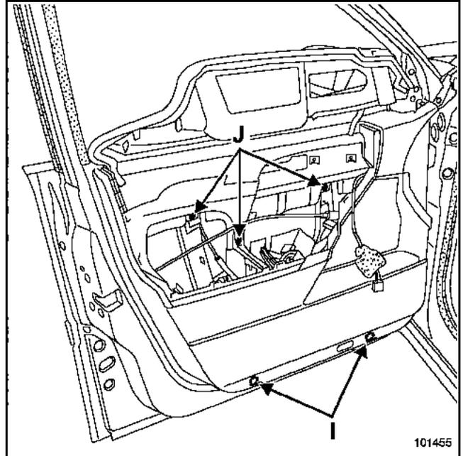
Die beiden unteren Schrauben (I) und die oberen Schrauben (J) anbringen.
