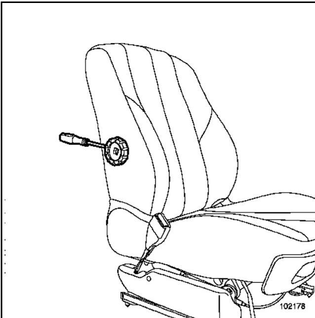
Das Handrad der Lendenstützeneinstellung mit einem Schraubendreher ausbauen.
