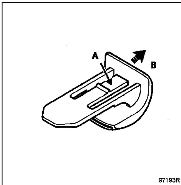
Die zwei oberen hinteren Klammern der Verkleidung lösen.
