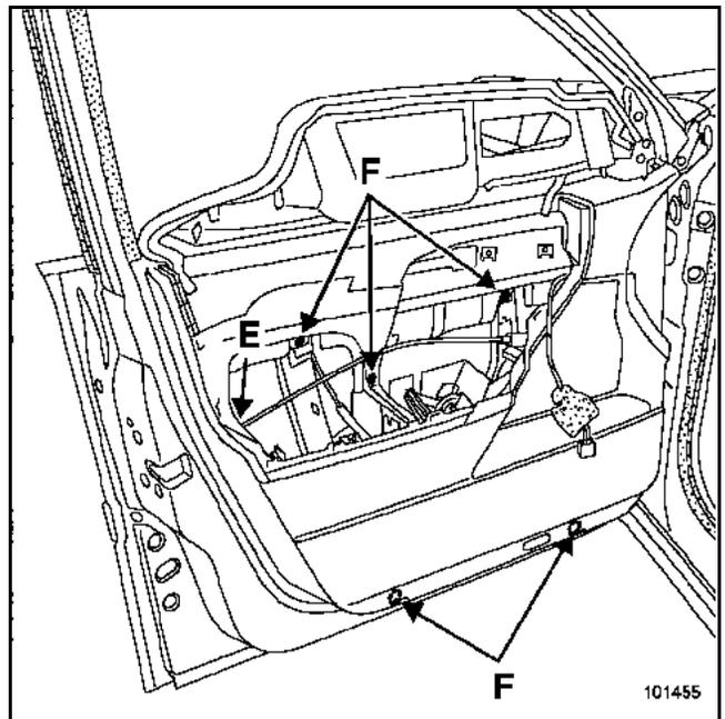
Den Schließmechanismus-Stecker (E) sowie die zwei Stecker des Griffmoduls abziehen (falls das Fahrzeug über die Funktion Keyless Entry&Drive verfügt).
