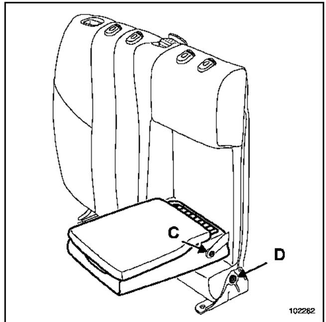
Die Schrauben (C) und (D) entfernen.
