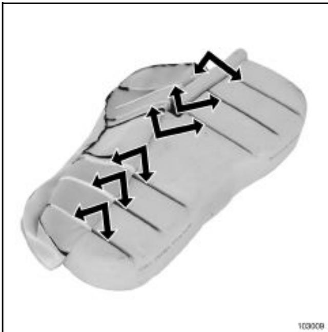
Die Klettverbindungen lösen.
