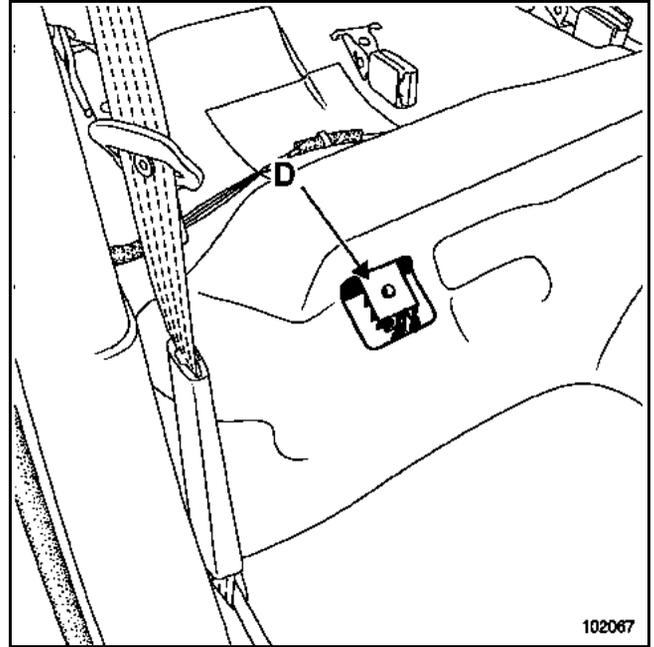
Einen Schraubendreher in die Aussparung (D) schieben.
