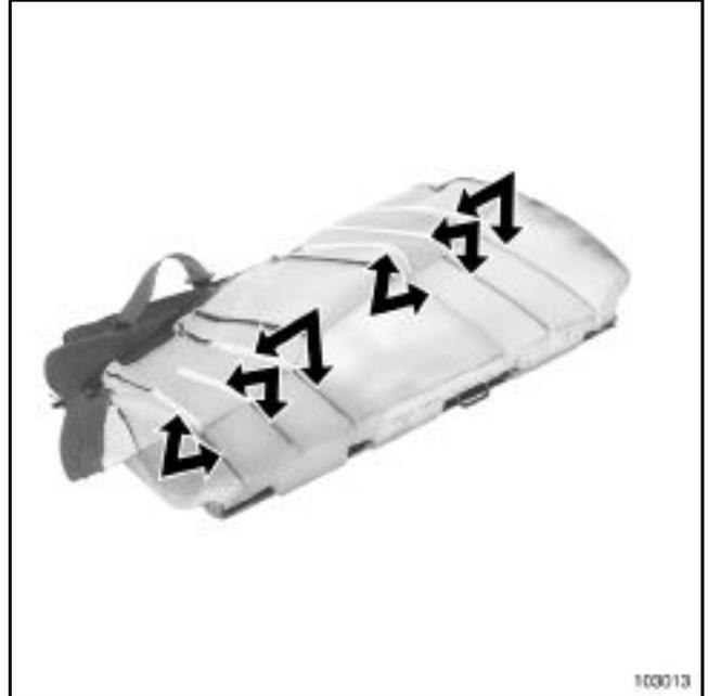
Die Klettverbindungen lösen.
