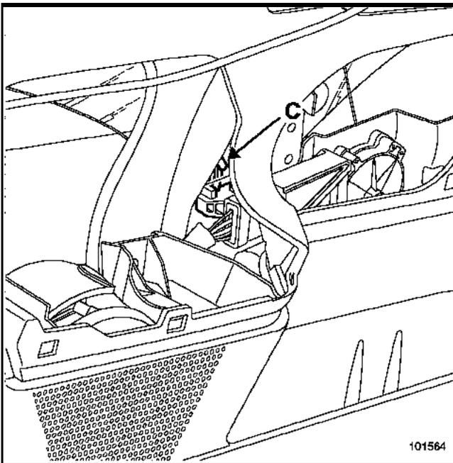
Die Nase (C) lösen; hierzu hierzu die Scheibe unter Zuhilfenahme eines Schlitzschraubendrehers nach oben ziehen.
