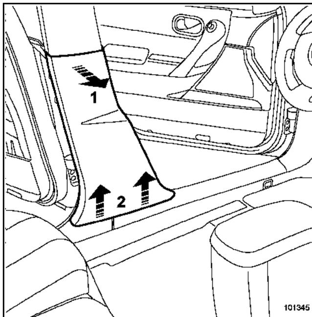
Die Verkleidung im oberen Bereich lösen (1).
