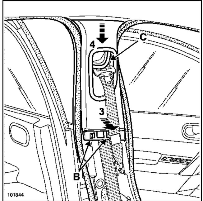
Die Türdichtungen teilweise lösen.
