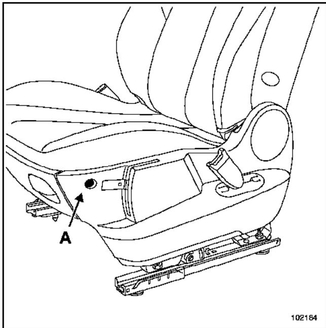
Die Schraube (A) des Gehäuses entfernen.
