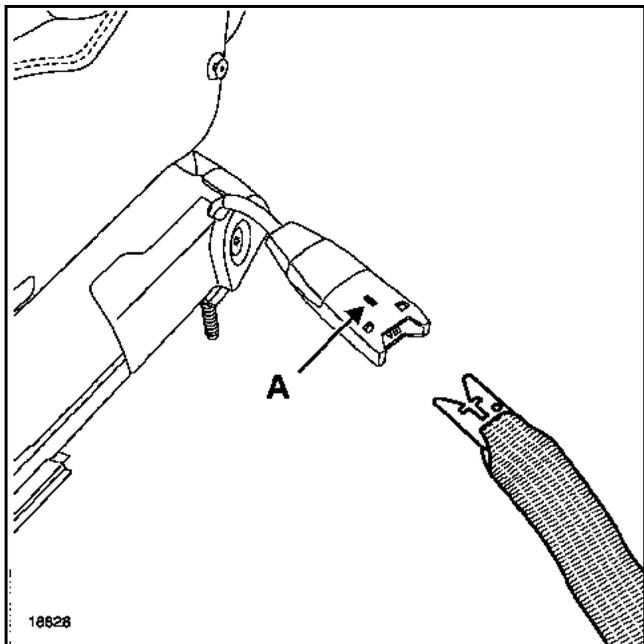
Den Sicherheitsgurt durch Drücken auf die Verriegelung (A) lösen.
