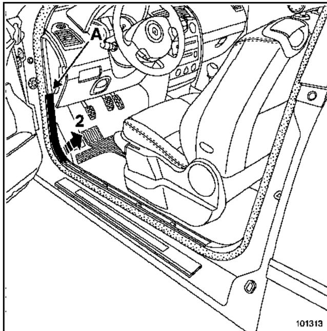
Das Seitenteil des Armaturenbretts lösen.
