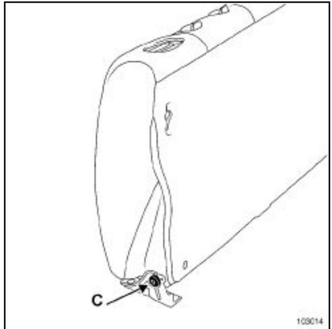
Die Schrauben (C) entfernen.
