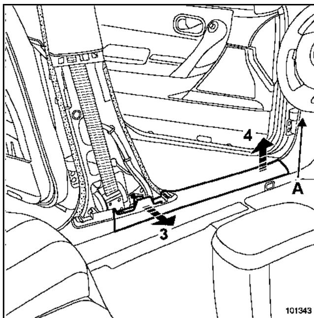
Das Seitenteil des Armaturenbretts lösen.
