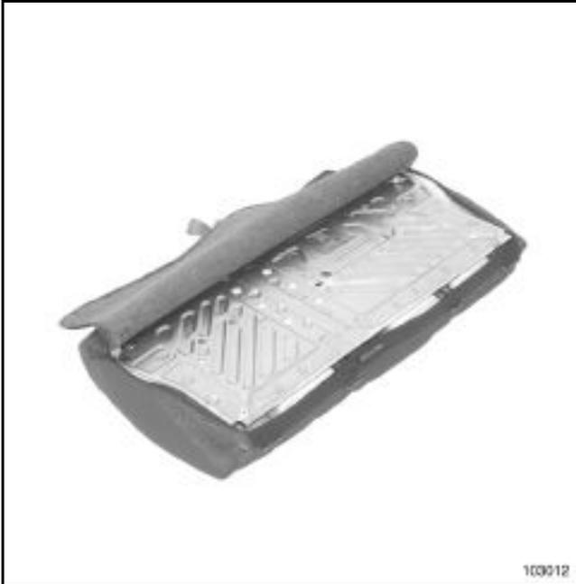
Den Bezug teilweise abgarnieren, um an die Kopfstützenführungen zu gelangen.
