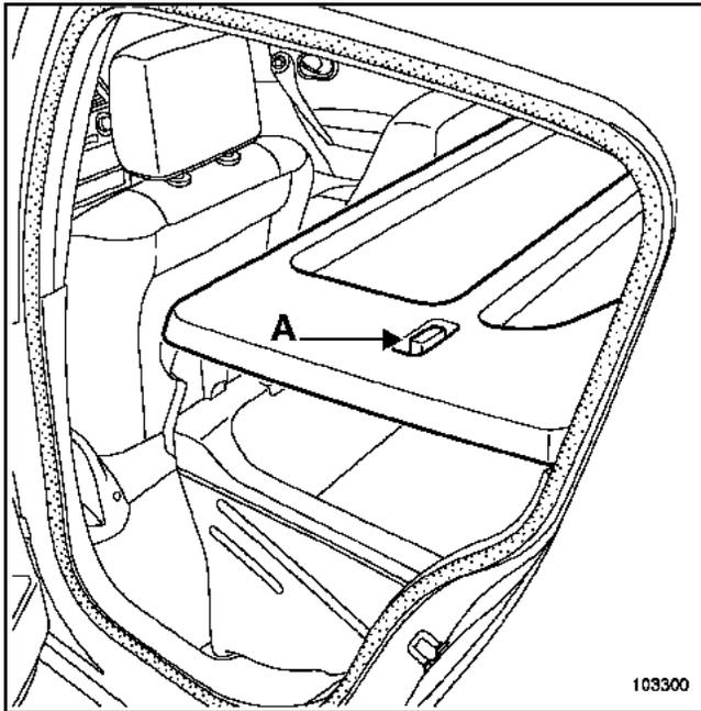
Die beiden Verriegelungen (A) lösen.
