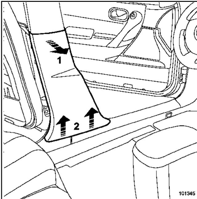
Die Verkleidung im oberen Bereich lösen (1).
