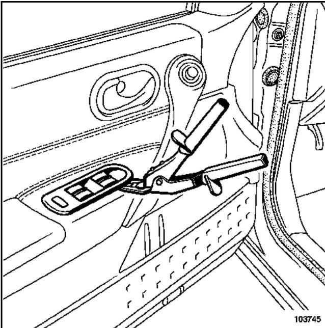
Die Verkleidung schützen (beispielsweise mit einem Schneidwerkzeug) und mit Hilfe der Ausbauzange den Träger der Fensterheberschalter lösen.
