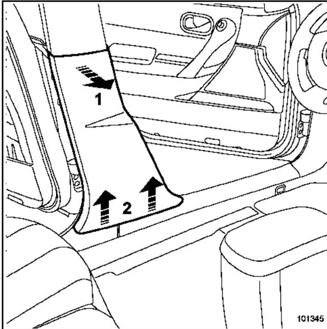
Die Verkleidung im oberen Bereich lösen (1).
