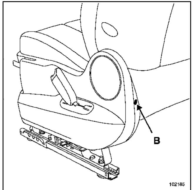
Die Schraube des Gehäuses (B) entfernen.
