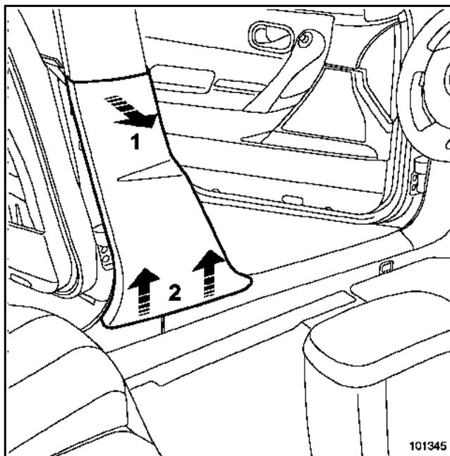
Die Verkleidung aus der Halterung lösen (1).
