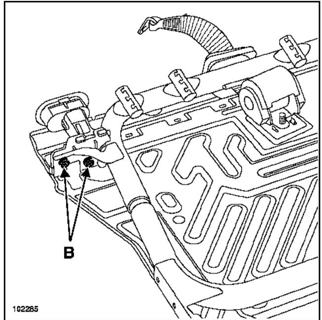
Die Schrauben des Verriegelungsmechanismus der Rückenlehne (B) entfernen.
