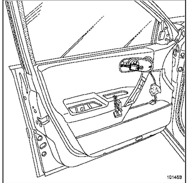
Die Abdeckung der Befestigung des Seilzugs des Schließmechanismus mit Hilfe eines Schlitzschraubendrehers lösen.
