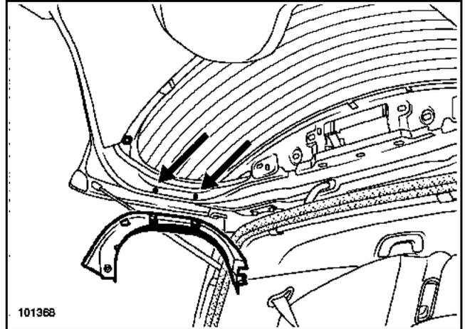
Die seitliche Verkleidung bei den beiden Klammern ablösen.
