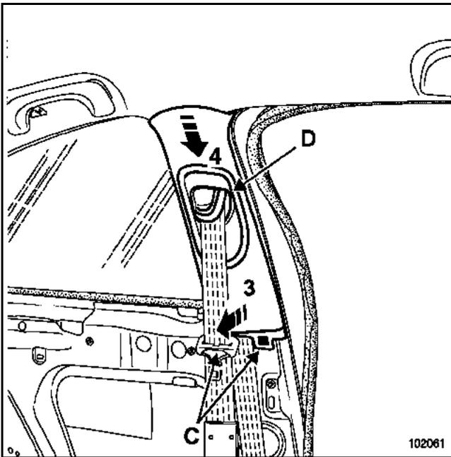
Die Türdichtung teilweise lösen.
