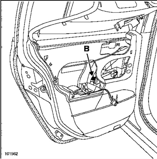
Die Scheibe so positionieren, dass die Halteklammer (B) zugänglich ist.
