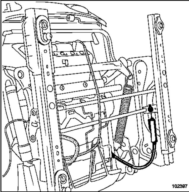
Die Seilzugarretierung ausrasten, um den Entriegelungshebel der Rückenlehne zu lösen.
