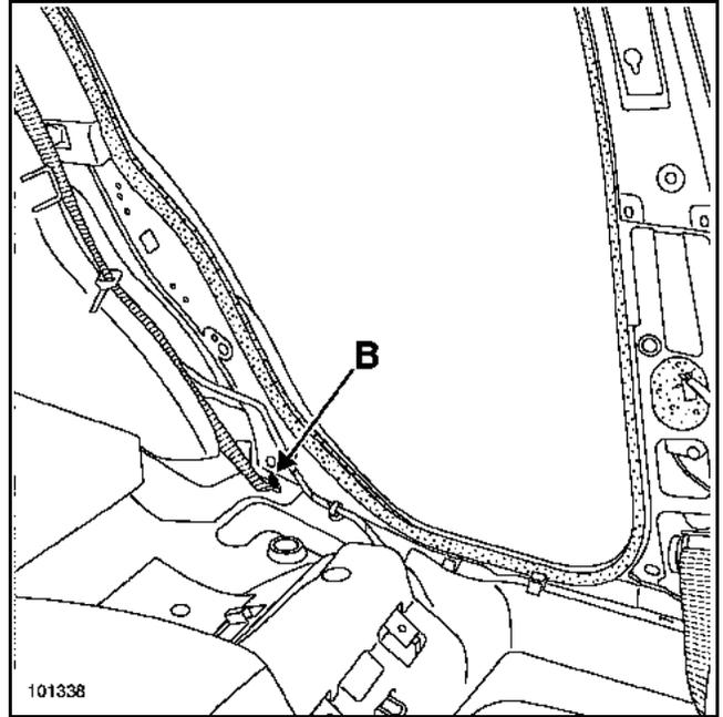
Die untere Befestigungsschraube des Sicherheitsgurts (B) lösen.
