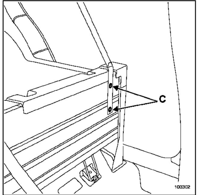
Die Schrauben (C) entfernen.
