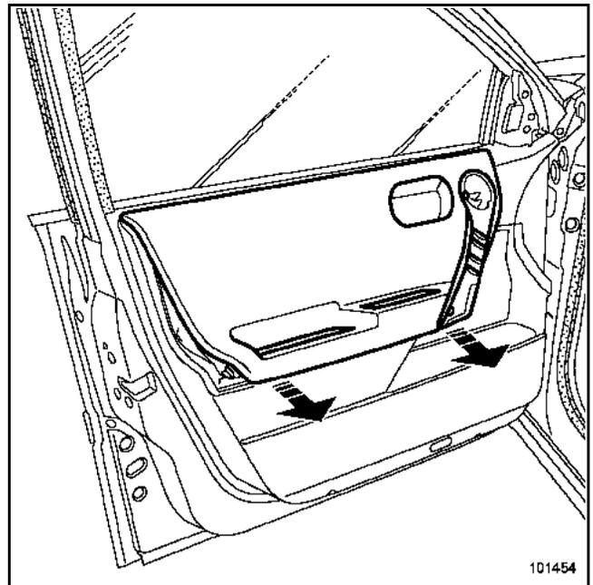
Die Klappe mit Hilfe der Ausbauzange von der Verkleidung lösen (die Verkleidung schützen).
