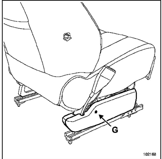
Die Schraube (G) des Gehäuses entfernen.
