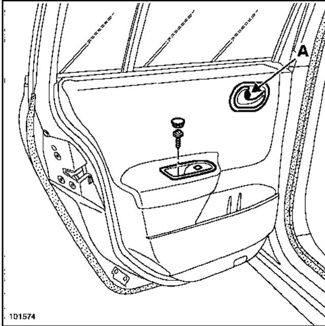
Die Abdeckung und die Schraube des Trägers der Fensterheberschalter entfernen.
