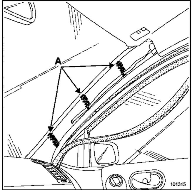
Vor dem Einbau der Verkleidung den Zustand der Klammern (A), Teile-Nr. **82 00 100 314** prüfen.
