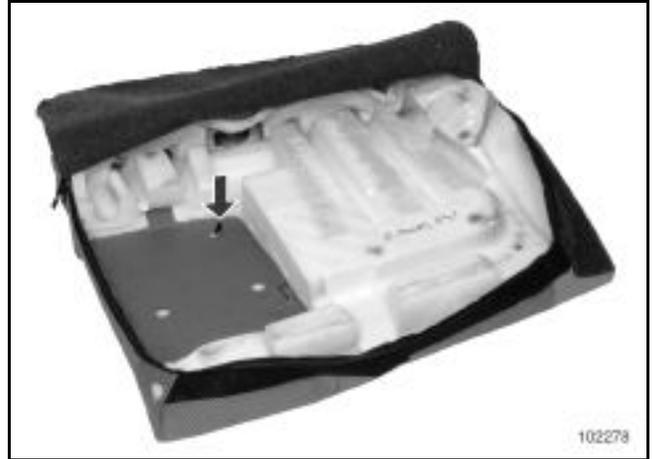
Die Klammer der Innenverkleidung lösen.
