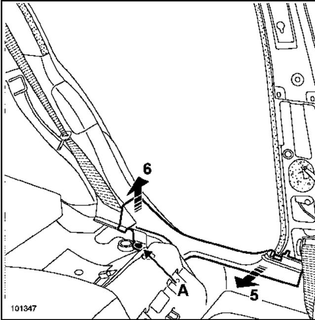
Die Klammer (A) mit Hilfe einer Ausbauzange entfernen.
