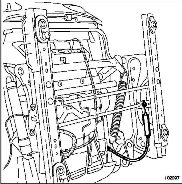
Die Seilzugarretierung ausrasten, damit an der Betätigung zur Entriegelung der Rückenlehne mehr Platz ist.
