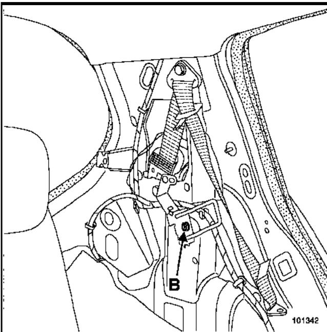
Die Befestigungsschraube der Falle der Rückenlehne (B) entfernen.
