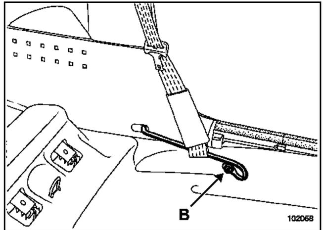
Die Schraube (B) der Schiene des Sicherheitsgurts entfernen.
