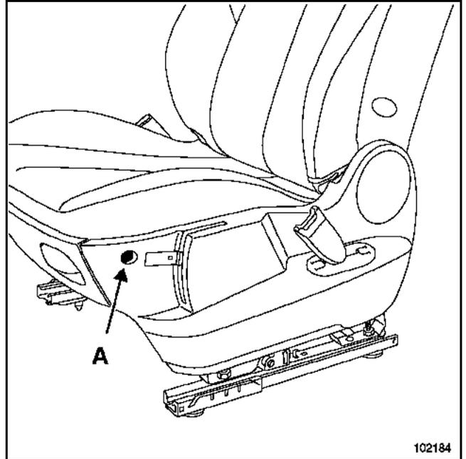
Die Schraube des Gehäuses (A) entfernen.
