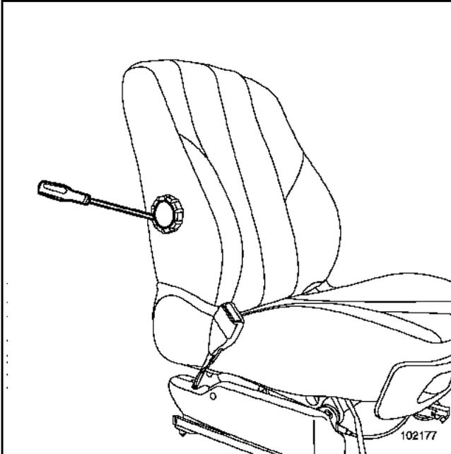
Die Blende der Befestigung des Handrads der Lendenstützeneinstellung mit Hilfe des Werkzeugs **Car. 1597** ausbauen.
