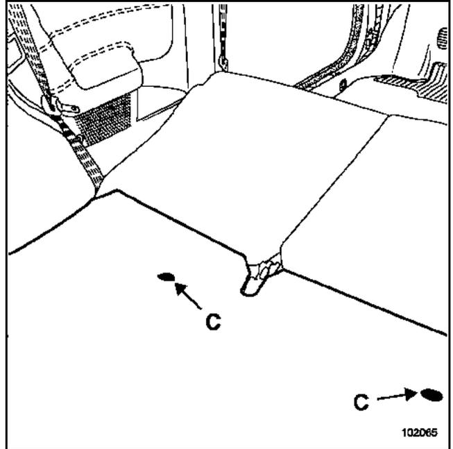
Die Klammern der Gepäckraummatte (C) mit Hilfe der Ausbauzange aushaken.
