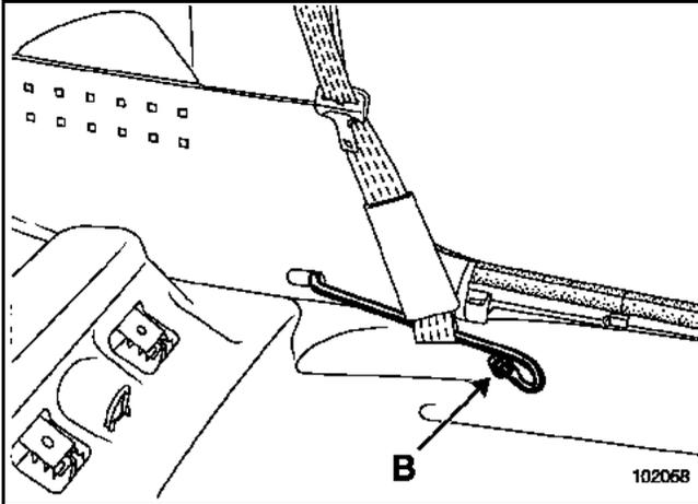
Die Schraube (B) der Schiene des Sicherheitsgurts entfernen.
