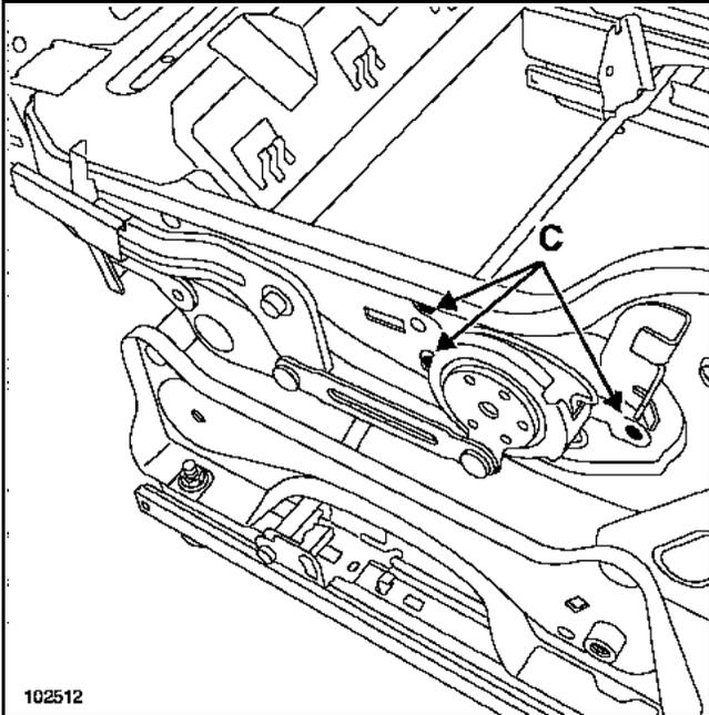
Die Nieten des Mechanismus zur Einstellung der Sitzerrhöhung (C) ausbauen.
